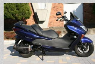
熱電発電マフラーを搭載したオートバイ。
